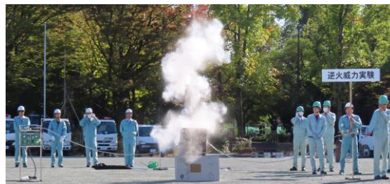
写真3 アセチレン逆火威力実験
